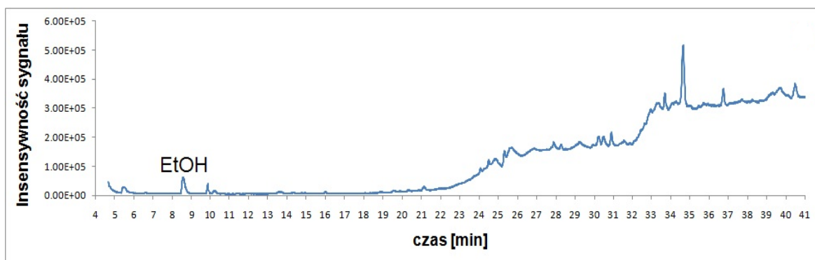
Rys. 15. Chromatogram zarejestrowany w trybie SCAN próbki pobranej ze skóry 23 letniej kobiety, niespożywającej alkoholu w okresie 48 h przed wykonaniem badania.
