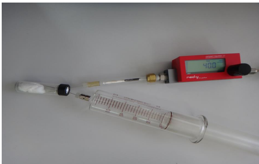
Rys.8. Desorpcja i zażęzanie analitów zaadsorbowanych na płątku kosmetycznym.
