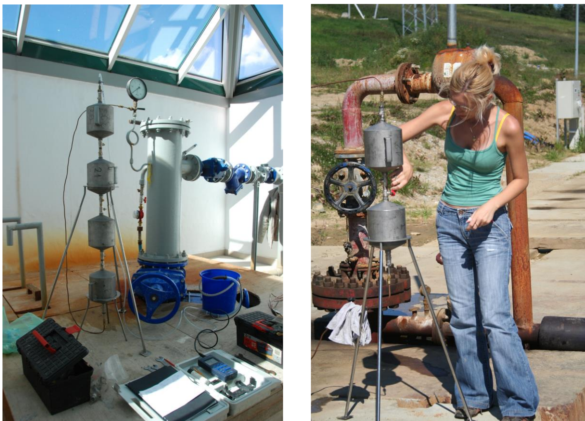
Rys. 20. Zmniejszenie ilości pobieranych próbek wody w terenie ze studni głębinowych z 4 do 2 pojemników
