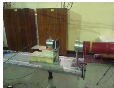
Rysunek 34. Układ do pomiaru wiązki protonów z usuniętym kolimatorem 30 mm.
