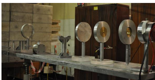
Rysunek 11. Zespół wykonanych uchwytów i kolimatorów wraz puszką Faraday'a.
