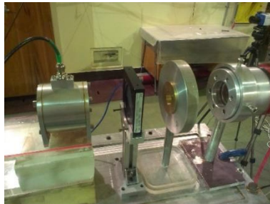
Rysunek 33. Układ do pomiaru wiązki protonów: puszka Faraday'a, komora jonizacyjna PTW, kolimator 30 mm.
