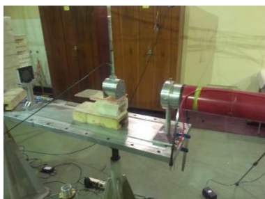
Rysunek 32. Układ do pomiaru wiązki protonów z usuniętą komorą jonizacyjną i kolimatorem 30 mm.
