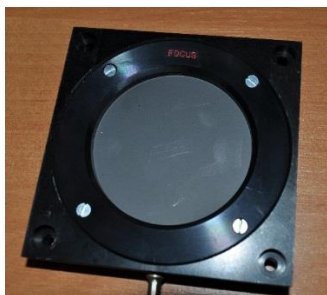
Rysunek 8. Monitorująca komora jonizująca PTW 7861.
