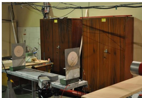
Rysunek 16. Układ dwóch tarcz fluorescencyjnych na tymczasowej ławie stanowiska.
