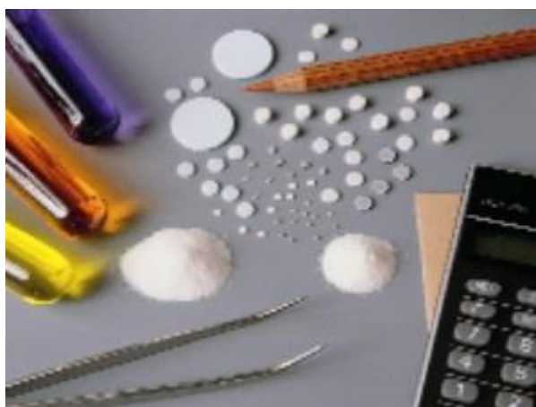
Rysunek 4.11. Różne postacie detektorów termoluminescencyjnych opracowanych w IFJ PAN [LADIS, Web].
