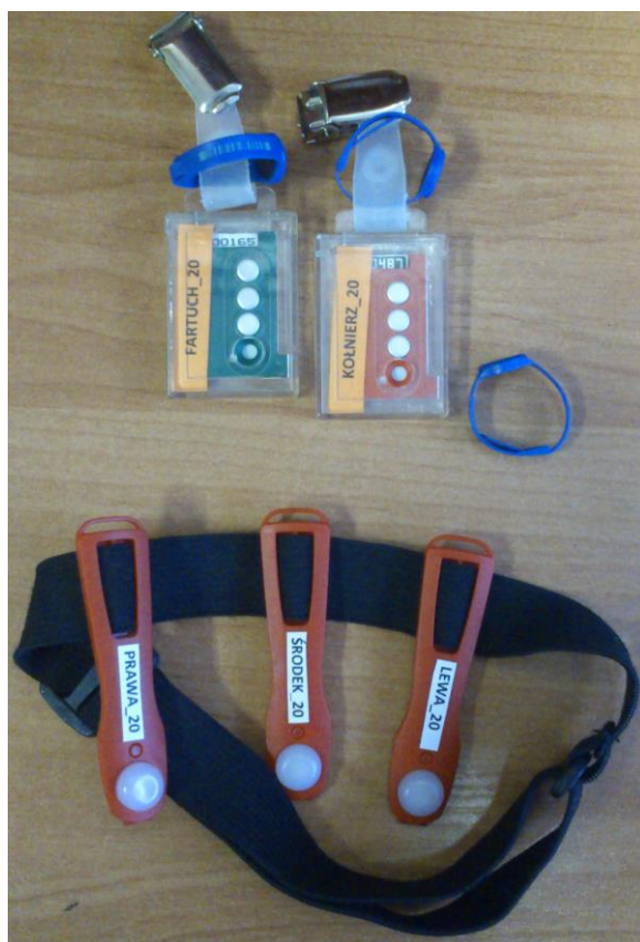
Fotografia 5.5. Komplet przygotowanych dawkomierzy wraz z oznaczeniami do pomiarów podczas procedury radiologii interwencyjnej.
