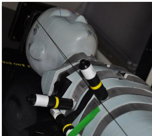
Rys. 4.14 Dodatkowe warstwy fantomu 5-latka z PMMA umożliwiające pomiary z zastosowaniem dużych detektorów pęcherzykowych, umieszczonych wewnątrz fantomu CIRS .
