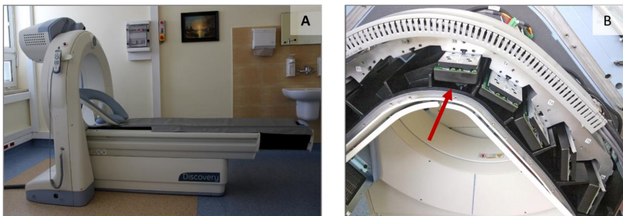
Rys. 3.9 A) Skaner Discovery NM 530c z detektorami CZT rozmieszczonymi w kształcie łuku; optymalne warunki dla stacjonarnej akwizycji SPECT serca uzyskuje się przez odpowiednie zbliżenie łuku z detektorami do ciała pacjenta; B) Układ detekcyjny w skanerze Discovery NM 530c widoczny po zdjęciu obudowy gantry. Detektory uformowane są w tzw. triplety (czerwona strzałka). Łączna liczba detektorów wynosi 19, a tripletów jest 9
