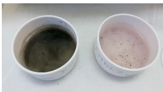
(c) Porównanie próbek filtrów ekspozycyjnych (po lewej) i filtrów nieekspozycyjnych (tzw. blank, po prawej) po 2 tygodniach działania kwasu HF
