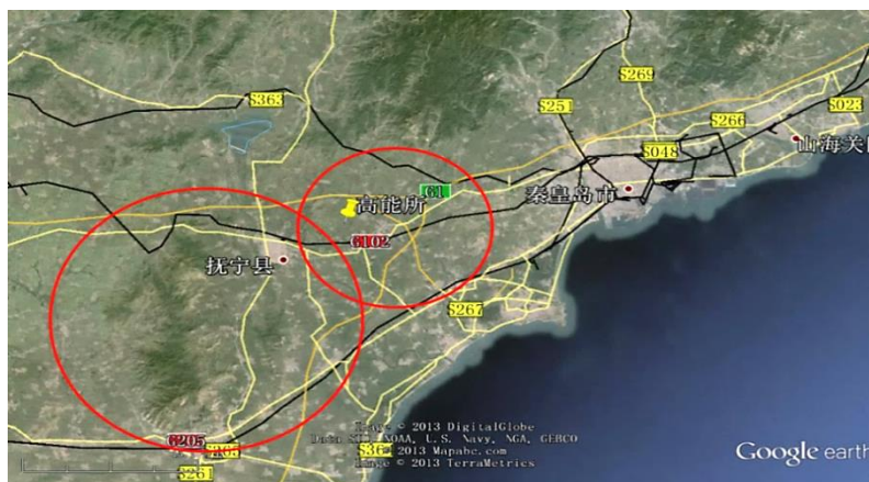
Rysunek 3.4. Możliwa lokalizacja CEPC w okolicy miasta Qinhuangdao po wybraniu jednej z koncepcji zderzacza (większy pierścień miałby obwód 100 km – zderzenia e^+e^- , mniejszy 80 km przeznaczony dla zderzeń pp) [66].
