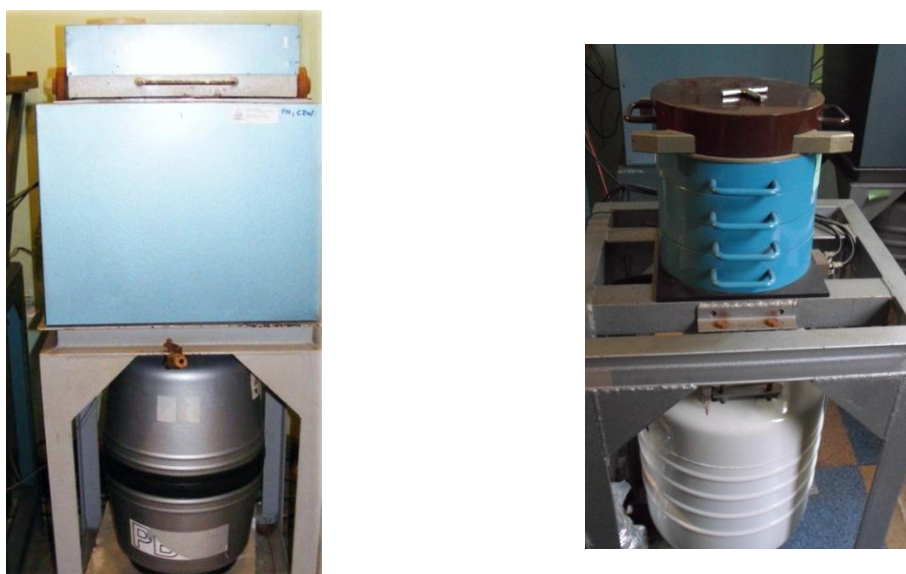
Rysunek 41. Fotografie dwóch spektrometrów promieniowania gamma, nr 1 i 4, znajdujących się w Zakładzie Fizykochemii Jądrowej, IFJ PAN.
