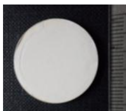
Rysunek 49. Źródłko z \alpha – emiterami umieszczone w spektrometrze promieniowania alfa.
