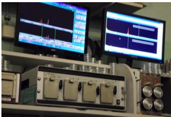
Rysunek 52. Wygląd zewnętrzny bloków spektrometrów promieniowania \alpha , na pierwszym planie czterokomorowy Alpha Quattro, znajdującymi się w Zakładzie Fizykochemii Jądrowej IFJ PAN, w Krakowie.
