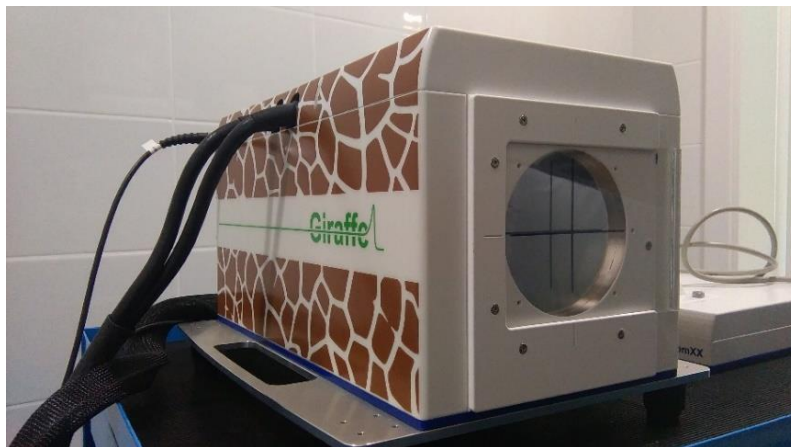
Rysunek 3.6 Przykładowy detektor typu MLC- detektor Giraffe (IBA-Dosimetry) składający się ze stosu 180 płasko-równoległych komór jonizacyjnych o średnicy 12 cm każda jest wykorzystywany w CCB do cotygodniowej weryfikacji zasięgu skanującej wiązki protonowej.
