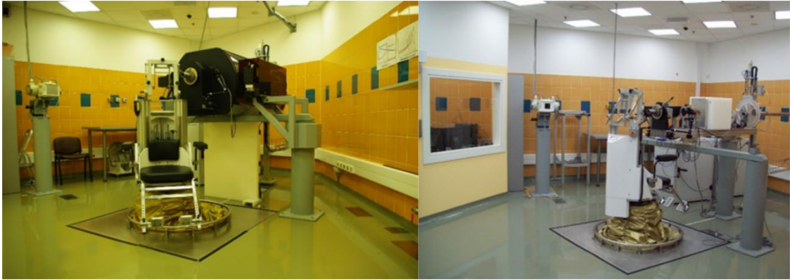
Rysunek 2.8 Stanowisko terapii oka z wiązką horyzontalną w Centrum Cyklotronowym Bronowice IFJ PAN; po lewej: widok na pokój terapeutyczny, po prawej: ława optyczna wraz z urządzeniami służącymi m.in. do pasywnego formowania wiązki protonowej (CCB IFJ PAN).
