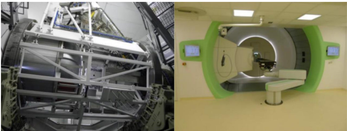
Rysunek 2.9 Stanowisko gantry w Centrum Cyklotronowym Bronowice IFJ PAN; po lewej: część techniczna stanowiska przedstawiająca konstrukcję stalową wraz z częściowym traktem wiązki, po prawej: widok pokoju terapeutycznego z widoczną głowicą (ang. nozzle ) oraz robotycznym stołem terapeutycznym (CCB IFJ PAN).
