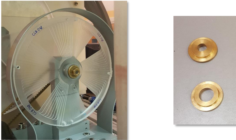
Rysunek 6.8 Elementy formowania wiązki w metodzie rozproszonej stosowane w CCB. Po lewej modulator zasięgu, po prawej przykłady kolimatorów.
