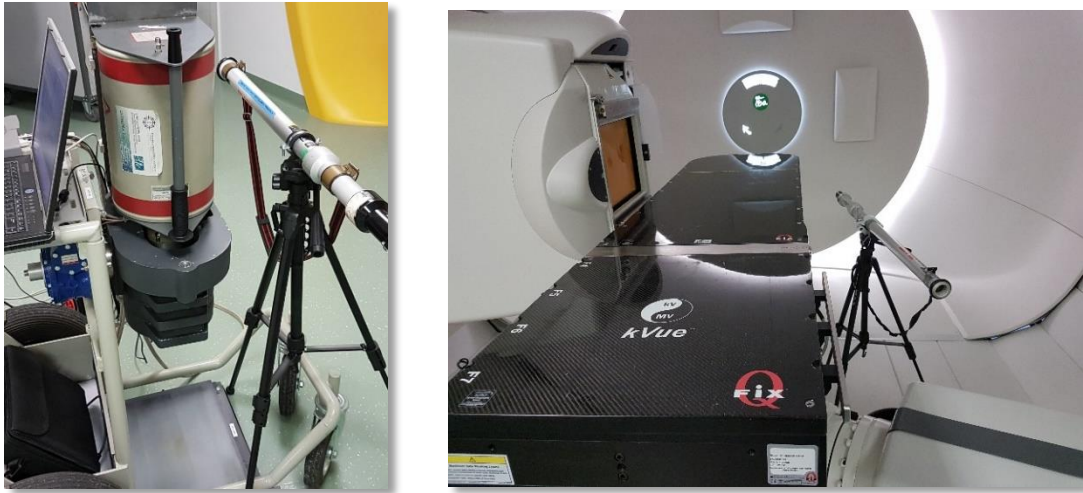
Rysunek 6.13 Układ pomiarowy na stanowisku gantry. Pomiar spektroskopowy modulatora zasięgu po lewej (fot. Szymon Guguła).
