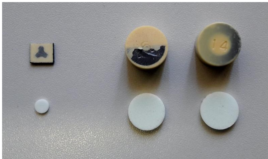
Rys. 92. Porównanie filtrów i detektorów do rozróżniania ekspozycji statycznej od dynamicznej. Dla energii do 250 keV (po lewej) oraz dla energii 661 keV( Cs-137) po prawej
