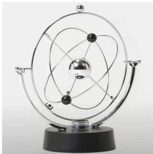
Rys. 91 Orbita kinematyczna używana do symulowania napromieniania dynamicznego. W środku, zamiast dużej kuli mocowany był dawkomierz)
