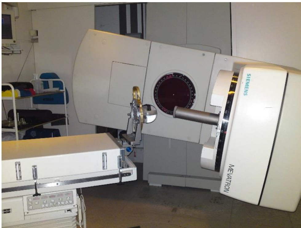
Rys. 62. Zdjęcie podczas eksperymentu z widocznym fantomem (przeźroczysta kula z PMMA i czarnym wkładem z detektorami)
