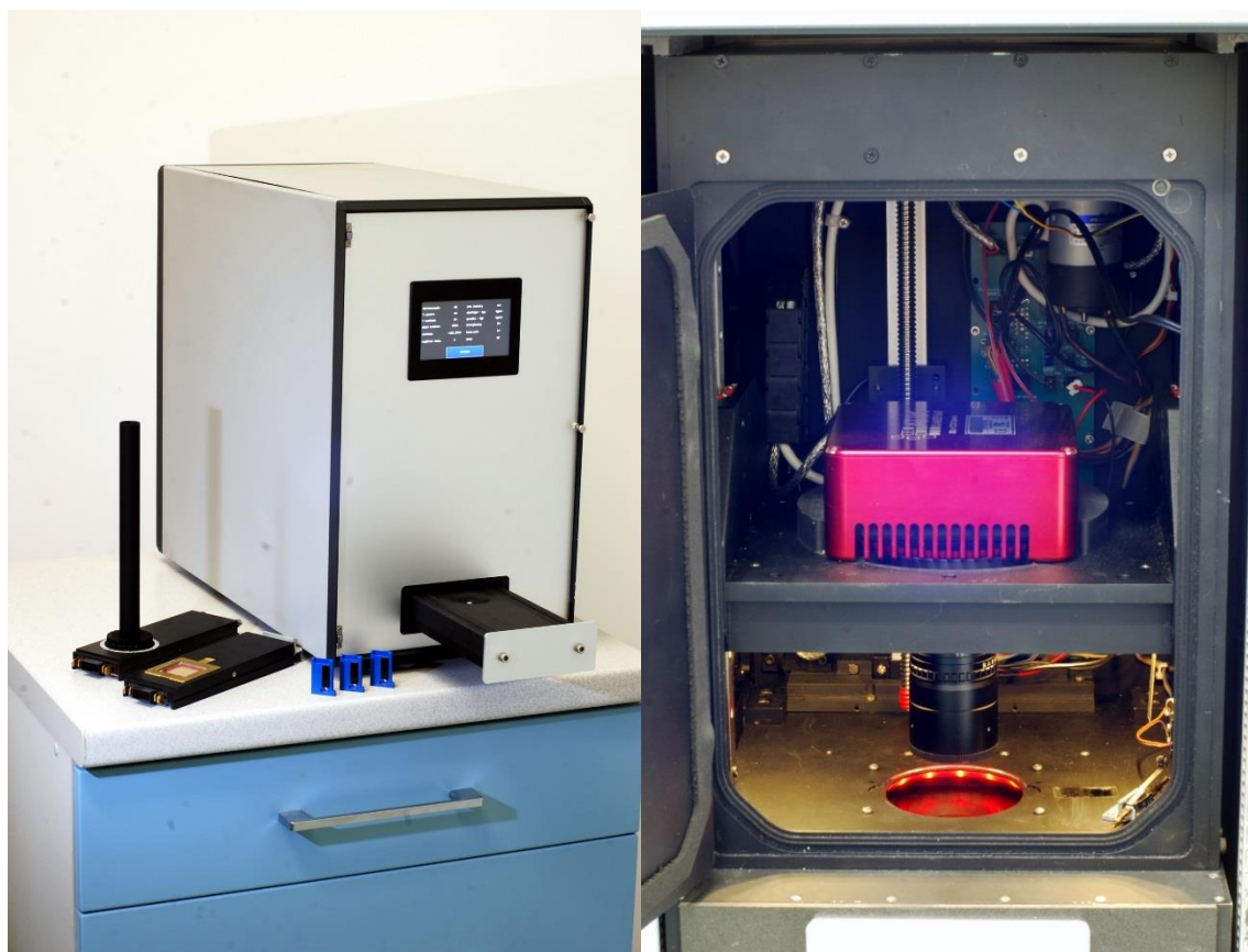
Rys. 39 Czytnik naukowy „Regulus”. Po lewej ogólny widok czytnika z wysuniętą szufladą do odczytu pastylek, obok widoczne są wymienne wkładki z grzałkami do odczytów spektralnych i małych detektorów powierzchniowych. Po prawej wewnątrz czytnika z widoczną kamerą.
