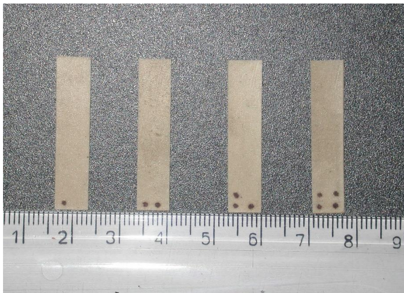
Rys. 103. Fotografia czterech detektorów powierzchniowych \text{CaSO}_4:\text{Dy} przygotowanych do pomiaru rozkładu głębokościowego.
