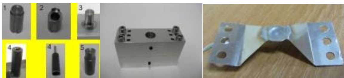
Rys. 40. Zespół narzędziowy do formowania grzałki i grzałka (po prawej)
