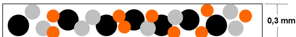
Rys. 18. Schematyczna ilustracja przekroju detektora o grubości 0,3 mm. Okręgi czarne, to ziarna o rozmiarze 125 mikrometrów, szare – 90 mikrometrów, pomarańczowe 75 mikrometrów.
