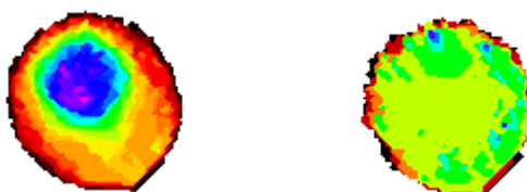
Rys. 93. Obraz rozkładu dawki detektorów napromienionych przy pomocy Cs-137 i dawką 1 mSv w sposób statyczny (po lewej) i dynamiczny (po prawej).
