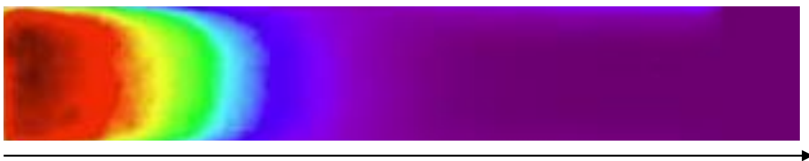
Rys. 104. Obraz uzyskany z detektora powierzchniowego TL, po ekspozycji pod klinem na promieniowanie beta ze źródła \text{Sr-90/Y-90} . Strzałka wskazuje kierunek wzrostu głębokości.
