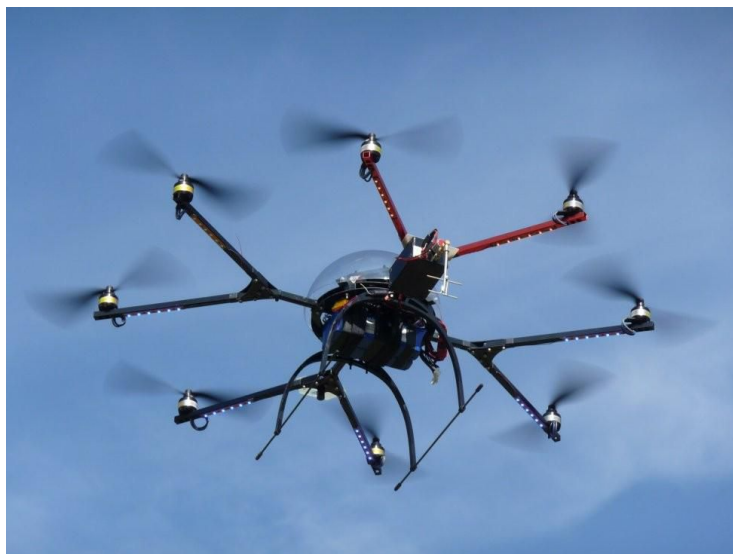
Rysunek 57: Oktokopter o średnicy 80 cm używany do kalibracji detektora CROME (fot. F. Werner).
