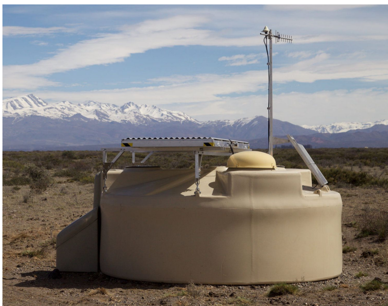
Rysunek 77: Zdjęcie stacji czerenkowskiej z zamontowanym plastikowym scyntylatorem (SSD, ang. Surface Scintillator Detector).
