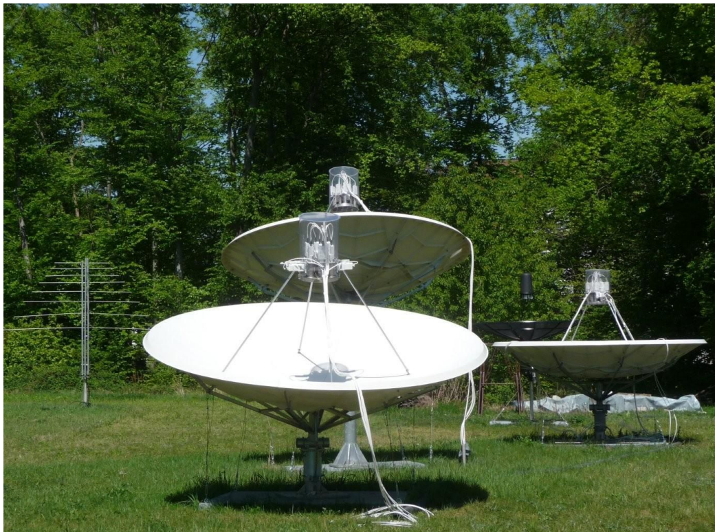
Rysunek 55: Trzy anteny odbiorcze pracujące w paśmie C, tj. w zakresie częstotliwości 3.4 - 4.2 GHz (fot. R. Smida). Oś jednej z nich jest pionowa, natomiast pozostałe dwie są odchylone, w przeciwnych kierunkach, o 15^\circ od zenitu.
