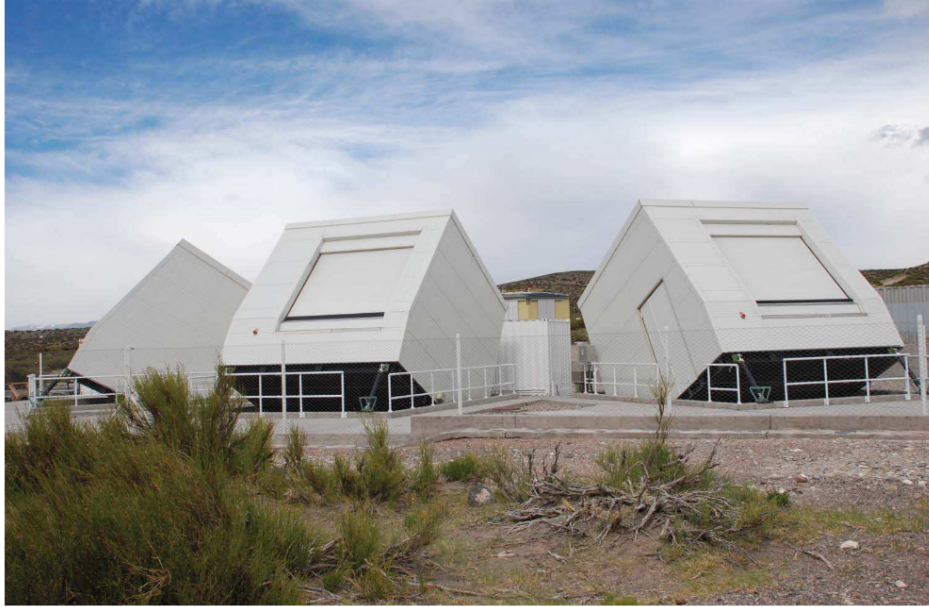
Rysunek 76: Detektor HEAT (ang. High Elevation Auger Telescopes) będący nisko-energetycznym rozszerzeniem detektora fluorescencyjnego (FD). Trzy teleskopy umożliwiają obserwację atmosfery pod większym kątem względem horyzontu niż w przypadku standardowych teleskopów FD. Pozwala to na rejestrację pęków o mniejszej energii, które osiągają maksimum swojego rozwoju wyżej w atmosferze.
