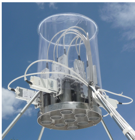
Rysunek 56: Kamera składająca się z układu 9 liniowo spolaryzowanych odbiorników, umieszczona w ognisku jednej z anten pracujących w wiodącym paśmie C (3.4-4.2 GHz).
