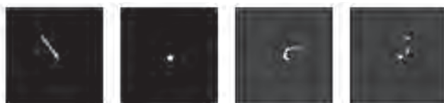
Rys. 5. Przykładowe ślady rozbłysków na matrycy kamery smartfona, od lewej do prawej: track, spot, worm, multiples
