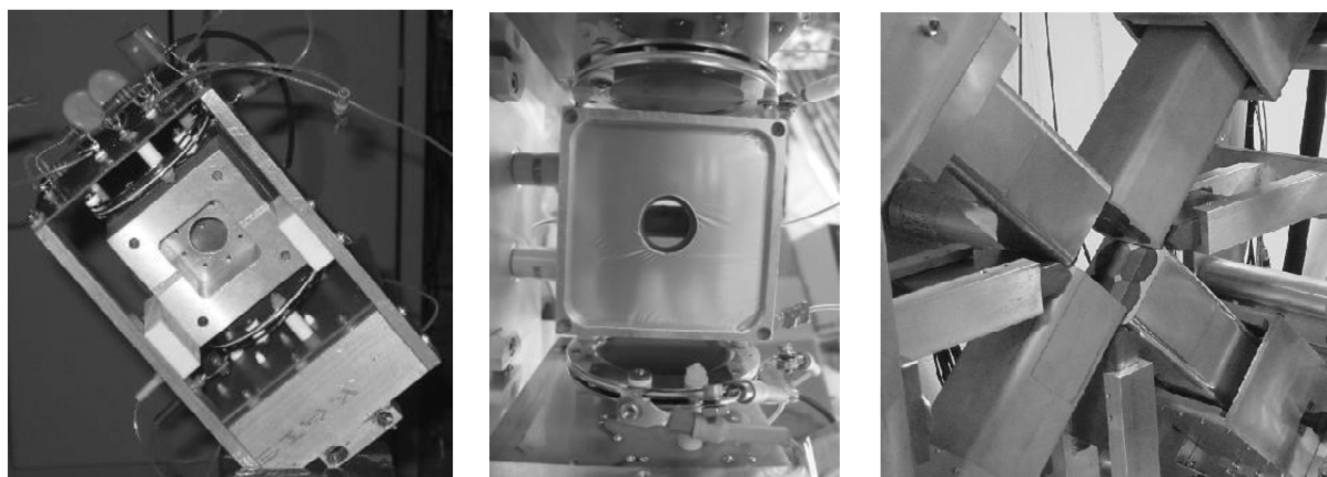
Rys. 7.8. Zdjęcia elementów układu Isomer-scope zbudowanego w HRIBF Oak Ridge do identyfikacji i badania izomerów w eksperymentach z wiązkami radioaktywnymi [Kro09A, Kro13]. Lewa strona: część układu składająca się z tarczy, jej osłony oraz dwóch detektorów MCP wraz z dzielnikami napięcia widziana od strony przychodzącej wiązki. Środek: te same elementy widoczne z drugiej strony, na pierwszym planie widoczna jest folia mylorowa z otworem przepuszczającym wiązkę rozproszoną po przejściu przez tarczę. Prawa strona: CARDS, układ czterech detektorów germanowych typu Clover do detekcji promieniowania \gamma [Kro02, Bat03]. W otwór pomiędzy czołami detektorów mieści się jonowód wyprowadzający rozproszoną wiązkę.
