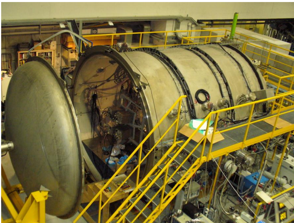
Rys. 3.9. Komora układu GARFIELD z widocznymi detektorami phoswich umieszczonymi w kierunku do przodu względem wiązki – układ stosowany podczas pomiaru rozpadu jądra ^{88}\text{Mo} (w LNL Legnaro).
