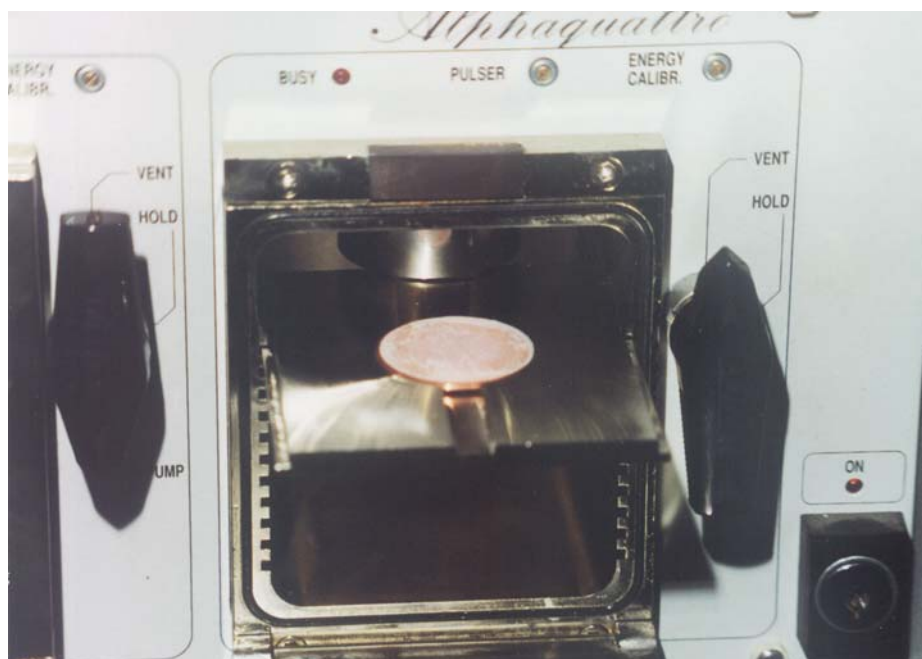
Fot. 5. Źródło \text{NdF}_3 w komorze pomiarowej spektrometru promieniowania alfa Silena.
