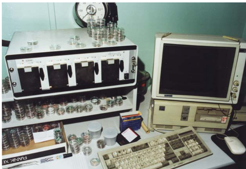
Fot.1. Czterokomorowy spektrometr promieniowania alfa Silena AlphaQuattro znajdujący się od 1995 w Laboratorium Badań Skażeń Radioaktywnych Środowiska IFJ.
