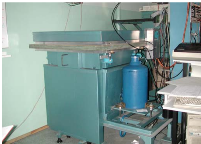
Fot. 3. Widok zespołu osłon niskotłowego spektrometru promieniowania gamma z osłoną czynną, Schemat konstrukcji osłony przedstawiono na rysunku 15.
