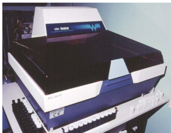
Fot. 2. Spektrometr ciekłoscyntyacyjny Wallac 1414-003 Guardian znajdujący się w Laboratorium Badań Skażeń Radioaktywnych Środowiska IFJ.
