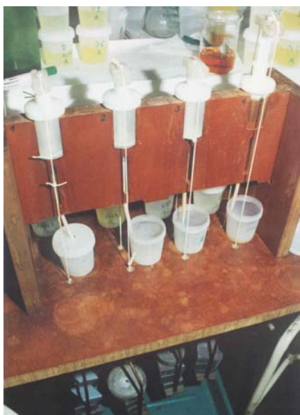
Fot. 4. Układ ciśnieniowej chromatografii jonowymiennej.
