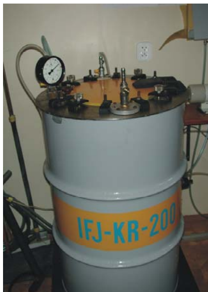
Rys. 1. Kalibracyjna komora radonowa IFJ-KR-200.
