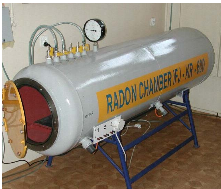
Rys. 2. Kalibracyjna komora radonowa IFJ-KR-600
