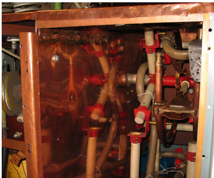
Rys 8. Fragment stopnia mocy generatora w.cz. po naprawie masy i ekranu.
