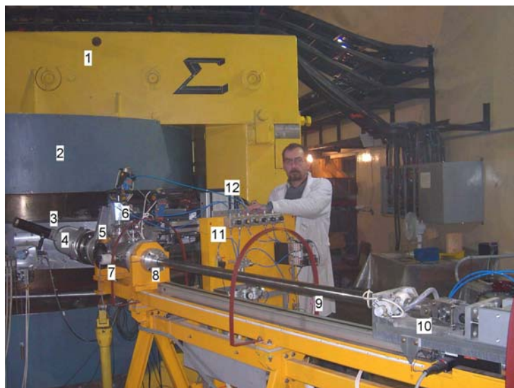
Rys. 3. Sonda izotopowa podpięta do komory akceleracji cyklotronu AIC-144. Stan z roku 2006
