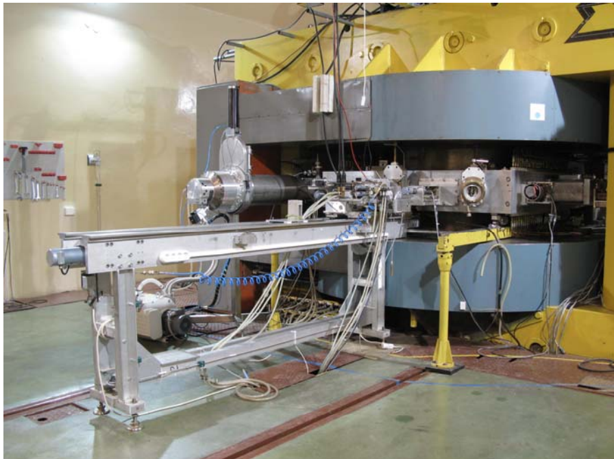
Rys. 1. Widok cyklotronu AIC-144. Na pierwszym planie źródło jonów typu PIG. Widoczne jest doprowadzenie gazu do źródła giętką, spiralną rurką (koloru niebieskiego), w tle jedna z pomp turbomolekularnych z zaworem odcinającym.
