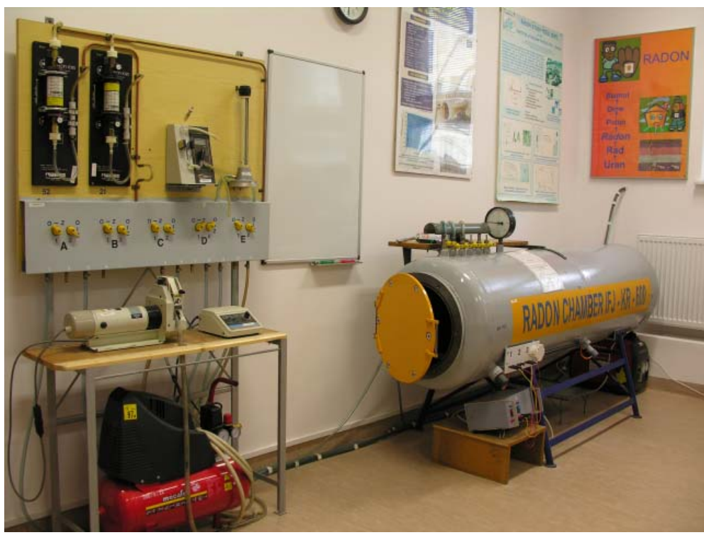
Rysunek 6. Komora radonowa KR-IFJ-600 wraz z tablicą sterującą.
