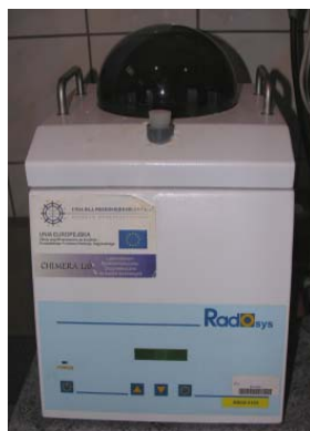
Rysunek 4. RadoBath do wytrawiania detektorów Cr-39.
