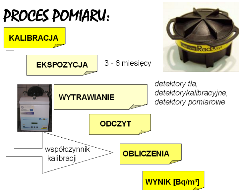
Rysunek 8 Schemat procesu pomiaru i odczytu detektorów CR-39.
