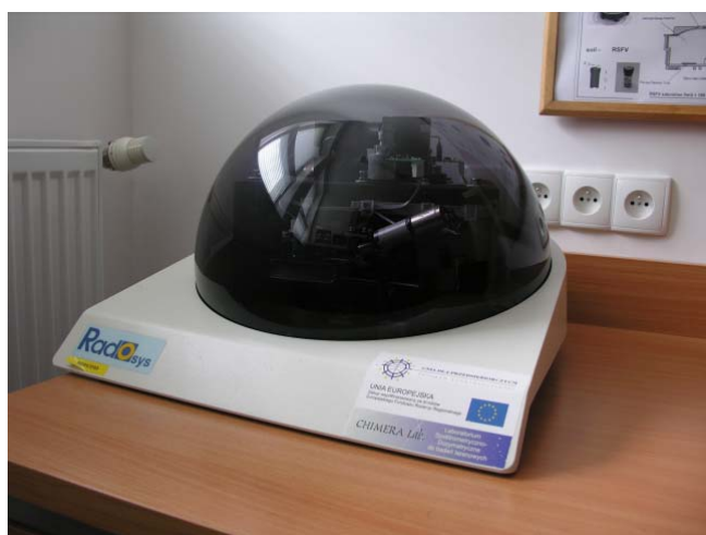
Rysunek 7. The RadoSys 2003 - czytnik detektorów CR-39.
