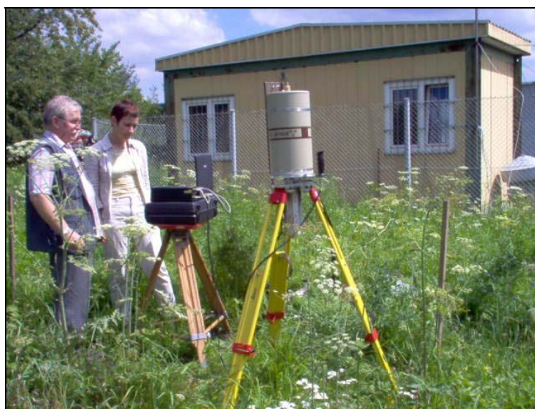
Rys. 4.6. Pomiar gamma spektrometryczny in situ na terenie RSF
