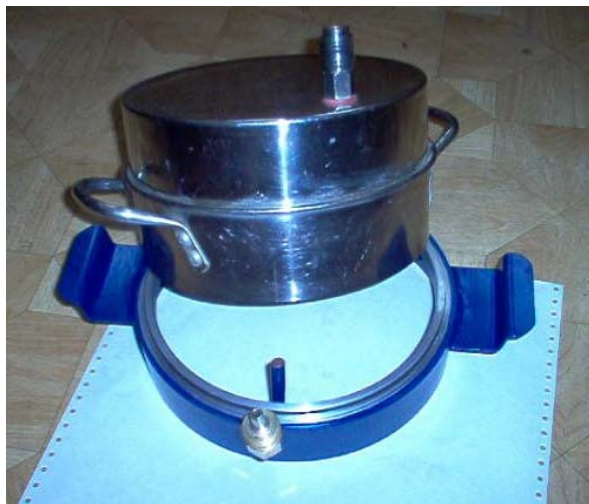
Rys. 5.3. Komora ekshalacyjna oraz pierścień mocujący do gleby
