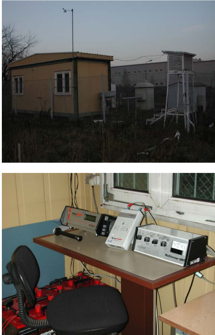
Rys. 4.2. Radon Study Field – kontener z aparaturą i stacja meteorologiczna Weather Monitor
