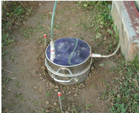
Rys. 5.2. Komora ekshalacyjna w czasie pomiaru
