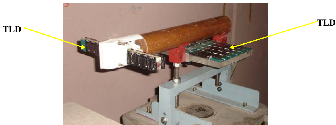
Rys. 3.3.9.2. Rozmieszczenie detektorów na miedzianej tarczy wiązki SPS w CERN-ie w czasie jednego z eksperymentów w polu eksperymentalnym CERF.
