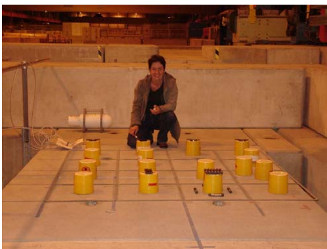
Rys. 6.3.3. Testy detektorów TL na polu CT eksperymentalnego pola promieniowania CERF w CERN.
