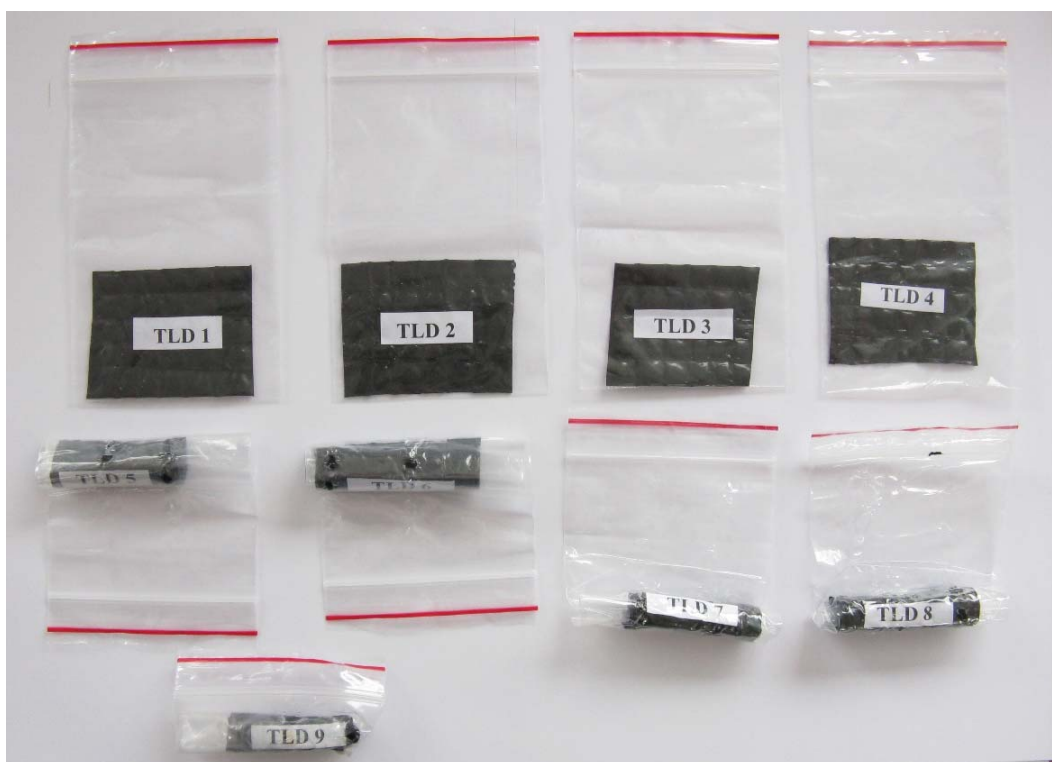
Rys. 3.3.10.1. Poekspozycyjna fotografia próbek poddanych naświetlaniom neutronami termicznymi i epitermicznymi w reaktorze TRIGA Mark II, uwidoczniająca przegrzanie próbek poddanych najwyższym fluencjom neutronów.
