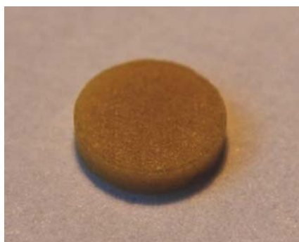
Rys. A.2. Fotografia ilustrująca zabarwienie detektora LiF:Mg,Cu,P po naświetleniu dawką 1 MGy od elektronów o energii 10 MeV.
