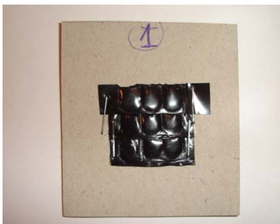
Rys. 3.3.7.2. Zdjęcie jednej z próbek z detektorami TL, przygotowanej na potrzeby eksperymentu na wiązce protonowej w Garching.
