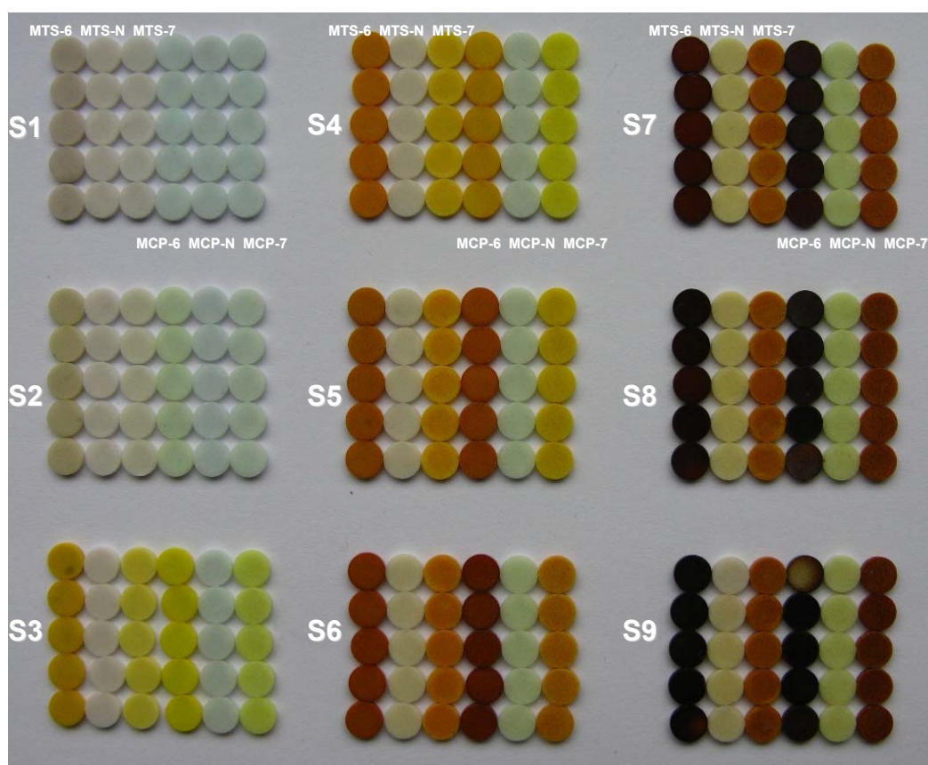
Rys. A.7. Fotografia ilustrująca zabarwienie różnych typów detektorów MCP i MTS po naświetlaniach strumieniem neutronów termicznych i epitermicznych w reaktorze TRIGA Mark II dla fluencji neutronów w zakresie 3 \times 10^{11} - 3 \times 10^{15} \text{ n/cm}^2 (próbki S1-S9).
