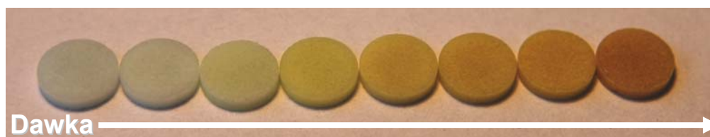
Rys. A.3. Fotografia ilustrująca zabarwienie detektorów LiF:Mg,Cu,P po naświetlaniach elektronami o energii 10 MeV dla zakresu dawek 75 kGy-1000 kGy.
