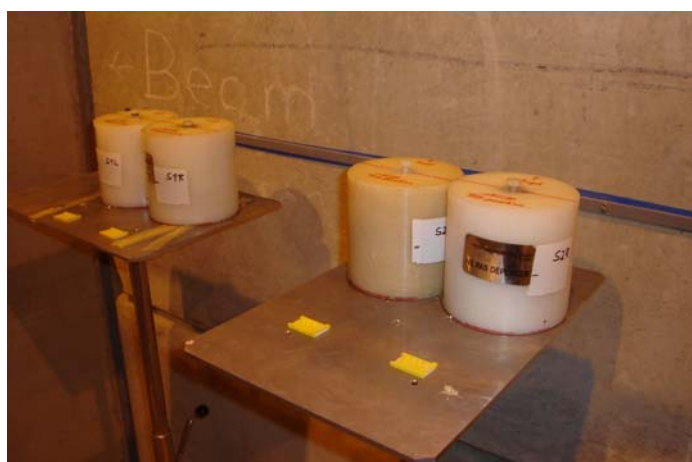
Rys. 3.3.9.3. Układ eksperymentalny naświetlań detektorów TL na pozycjach CS pola eksperymentalnego CERF z zastosowaniem cylindrycznych moderatorów z PMMA o średnicy 25 cm.
