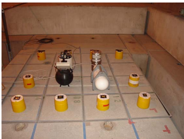
Rys. 3.3.9.1. Rozmieszczenie detektorów TL na pozycjach CT pola eksperymentalnego CERF w czasie eksperymentu.
