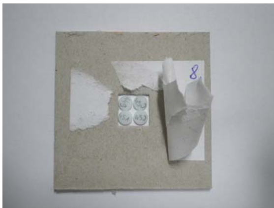
Rys. 3.3.8.3. Zdjęcie pojedynczej warstwy próbki przygotowanej do naświetlań protonami.
