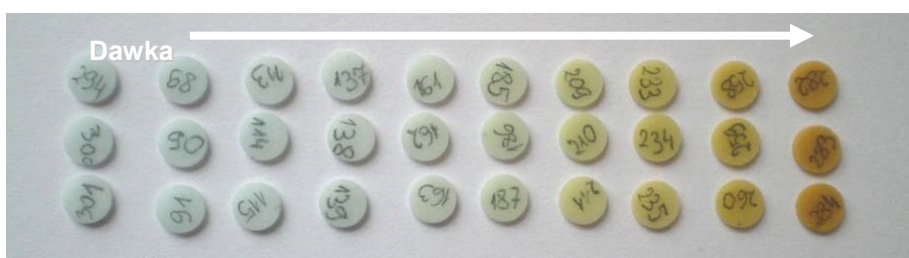
Rys. A.1. Fotografia ilustrująca zabarwienie detektorów LiF:Mg,Cu,P po naświetlaniach ^{60}\text{Co} dla zakresu dawek 0,5 kGy-500 kGy.
