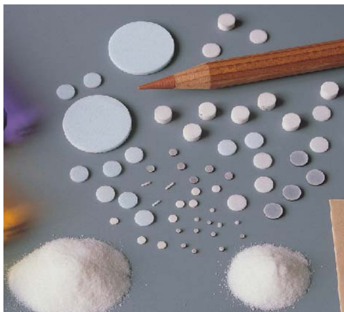
Rysunek 2.3.3.1. Detektory termoluminescencyjne w różnych postaciach, opracowane i produkowane w IFJ PAN.
