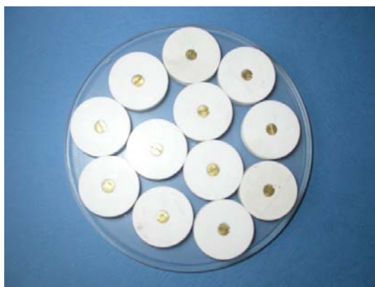
Rys. 3.3.6.1. Próbkami z detektorami TL przygotowane do naświetlań na akceleratorze elektronów w IChTJ.
