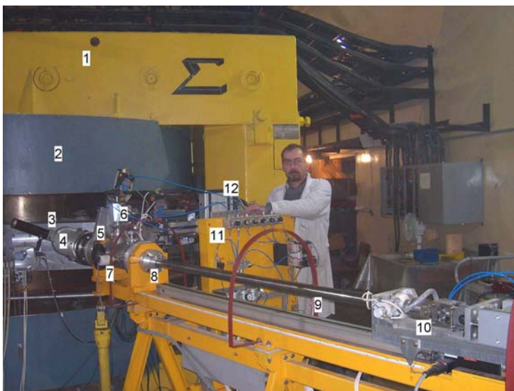
Rys. 5.3. Sonda izotopowa podpięta do komory akceleracji cyklotronu AIC-144. Stan z roku 2006
