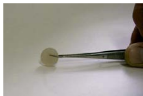
Rys 17.2. Zastosowana tarcza KI, \varnothing = 16 \text{ mm} , \rho = 838 \text{ mg cm}^{-2}
