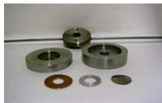
Rys 17.3. Elementy kapsuły do aktywacji KI i termicznego wydzielania ^{123}\text{I}
