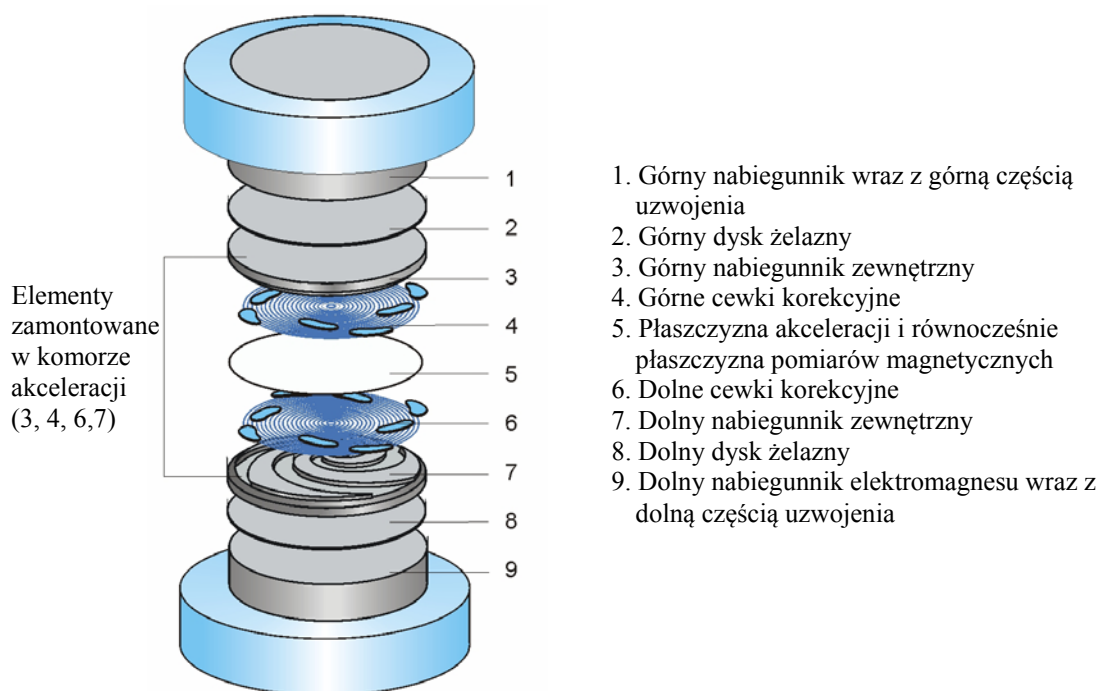
Rys.1 Budowa środkowej części obwodu magnetycznego. Dla przejrzystości pominięto komorę akceleracji oraz powiększono wielkość szczeliny między poszczególnymi elementami.
