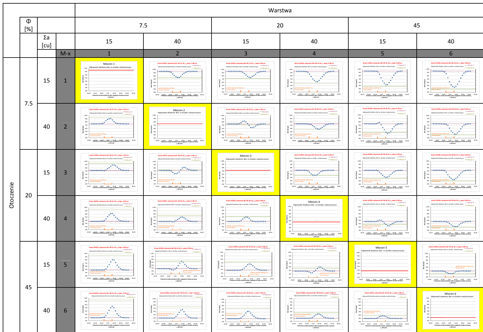
Fig. 10. Odpowiedzi detektora Bter w cieniwej warstwie o grubości H = 25 cm nachylonej do osi odwiertu pod kątem \alpha = 90^\circ .
