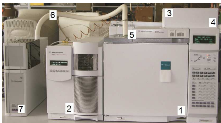
Rys.14. Chromatograf gazowy (1) sprzężony ze spektrometrem mas MS (2), wyposażony dodatkowo w detektor płomieniowo - fotometrycznym (3) oraz detektor wychwytu elektronów (4). Dodatkowo zaznaczono dozownik SPME (5) linię transferową (6) łączącą termiczny desorber (7) z GC.
