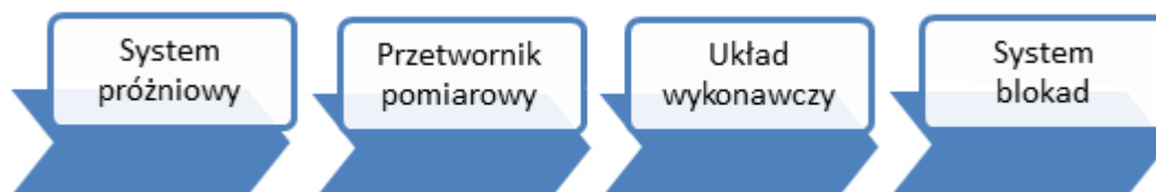
Rys. 12. Schemat blokowy wyjścia sygnału informującego o braku próżni roboczej.
