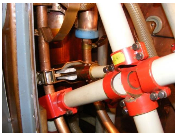
Rys. 6. Element strojeniowy końcowego stopnia wzmacniacza lampowego.
