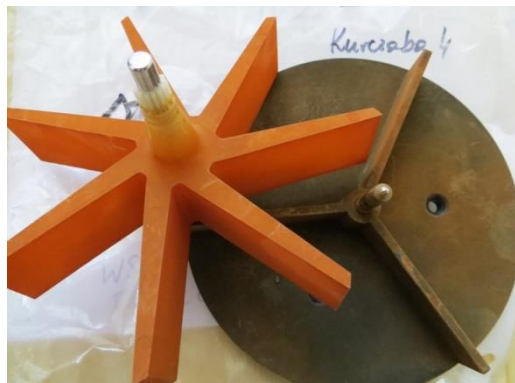
Rys. 4. Zdjęcie przedstawiające elementy wodomierza z którego odcięto badane fragmenty.
