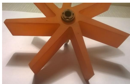
Rys. 25. Zdjęcie przedstawiające wirnik wodomierza, z którego pobrany został osad (próbka W8)
