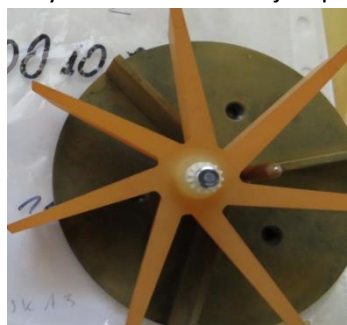
Rys. 14. Zdjęcie przedstawiające elementy wodomierza, z którego pobrano osad.
