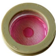
Rysunek 2. Szalka Perttiego z 10 mm otworem w dnie, pokryta folią Mylarową i wypełniona pożywką komórkową [4].
