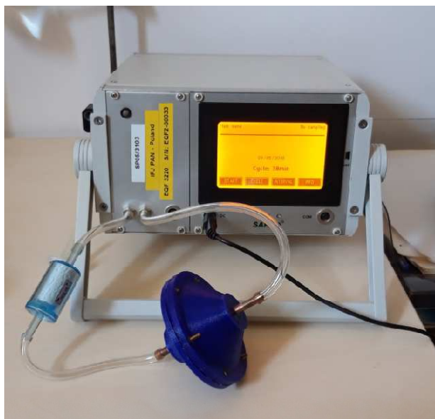
Rys. 4.8 Widok układu pomiarowego z wykorzystaniem miernika EQF 3220.
