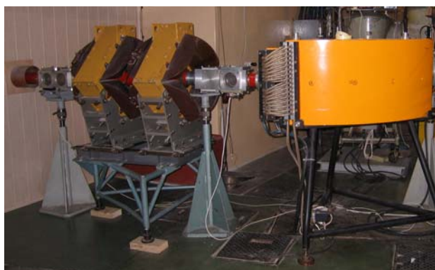
Rys 11. Trakt wiązki jonów w hali cyklotronowej (pomieszczenie C). Wiązka jest prowadzona od punktu 1: wyjścia z cyklotronu AIC-144 do punktu 2: przepustu w ścianie prowadzącej do pomieszczenia S.
