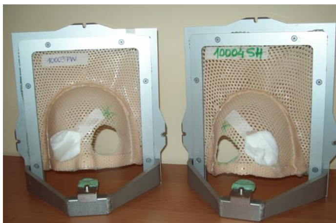
Rysunek 3.8 Elementy systemu unieruchamiania pacjenta, maski termoplastyczne oraz gryzaki zamontowane na ramach do fotela do radioterapii protonowej oka (fot. J. Swakoń).
