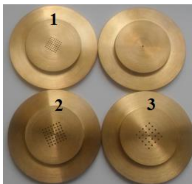
Rysunek 6.10 Kolimatory gridowe wyprodukowane w IFJ PAN, kolimator nr 1 (c-t-c 1,4 mm, d=0,7 mm), kolimator nr 2 (c-t-c 2,0 mm, d=1,0 mm), kolimator nr 3 (c-t-c 3,0 mm, d=1,0 mm). W prawym górnym rogu znajduje się jednootworkowy kolimator o średnicy otworu 1,0 mm, wykorzystany do pierwszego etapu eksperymentów.
