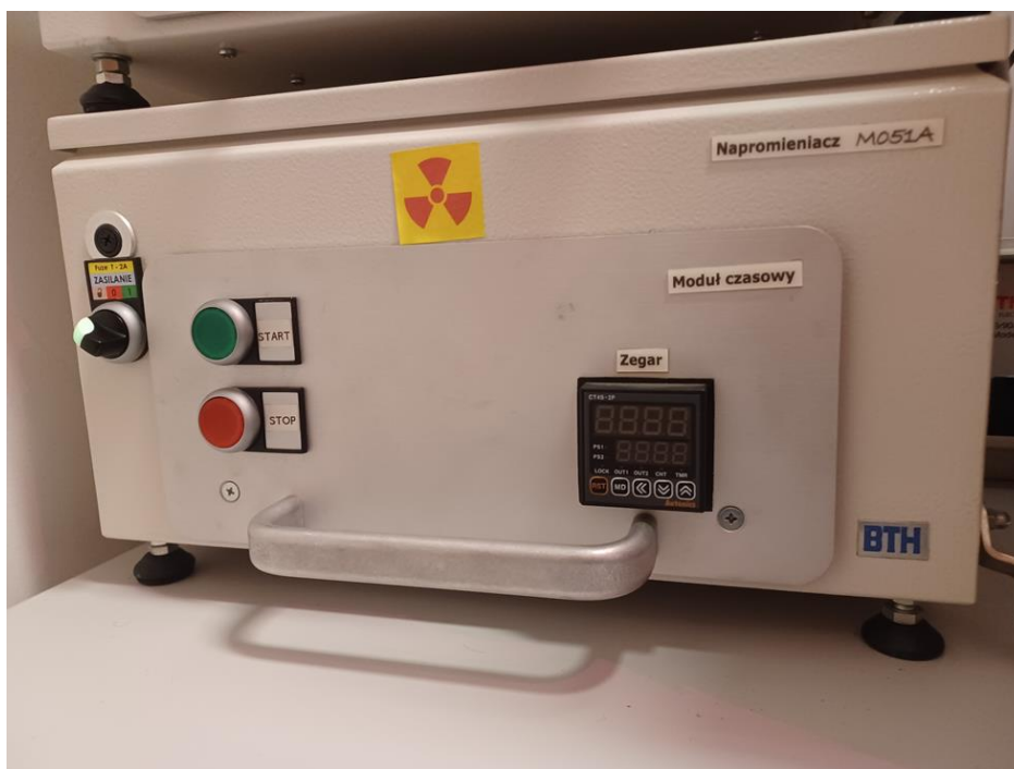
Rysunek 3.4. Napromniacz wyposażony w źródło promieniowania beta Sr-90/Y-90.
