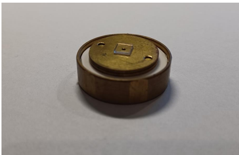
Rysunek 3.3. Próbkę z LiF napromieniana cząstkami alfa ze źródła Am-241 o aktywności 40 kBq z wykorzystaniem kolimatora.
