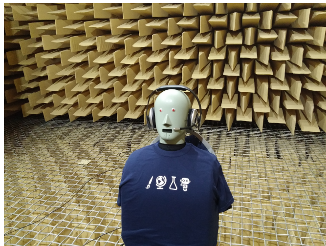
Rysunek 42: Konfiguracja 3, sztuczna głowa - słuchawki [źródło własne].
