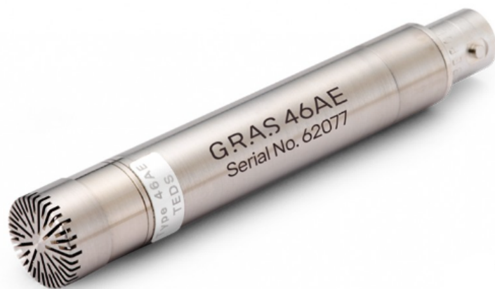
Rysunek 46: Mikrofon G.R.A.S 46AE użyty podczas badań w komorze bezchewej.
