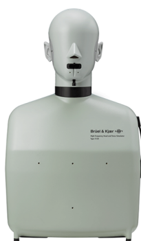
Rysunek 38: Sztuczna głowa: Head and Torso Simulator (HATS), typ 5128 [103].
