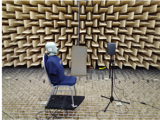
Rysunek 41: Konfiguracja 2, sztuczna głowa - głośnik [źródło własne].
