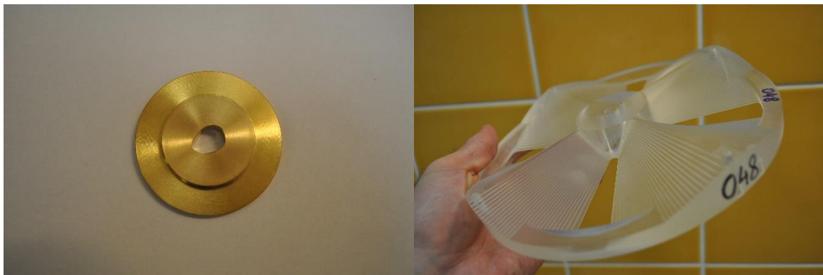
Rys. 5. Elementy formujące wiązkę protonową wykonywane lub dobierane indywidualnie dla pacjenta zgodnie z wymaganiami planu leczenia: indywidualny kolimator pacjenta (po lewej), śmigło modulatora zasięgu (po prawej).
