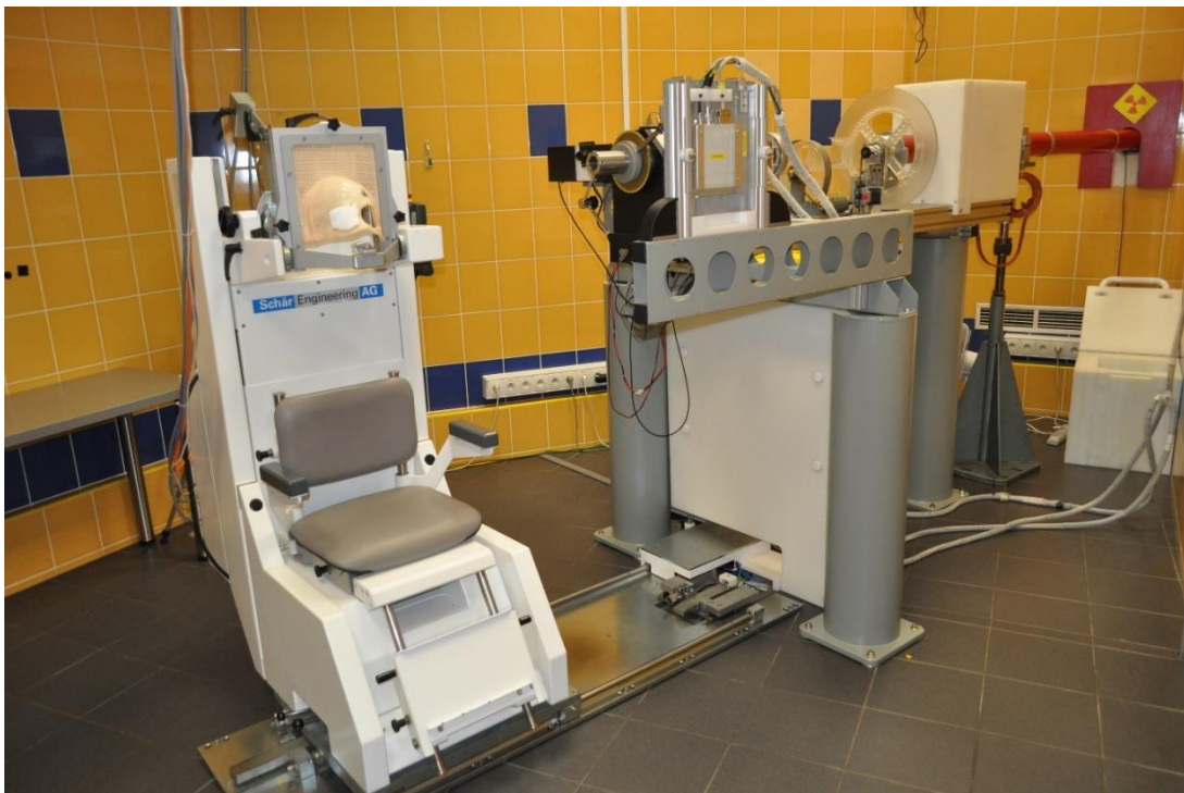
Rys. 1. Stanowisko radioterapii protonowej nowotworów oka przy cyklotronie AIC-144 - widok ogólny. Na pierwszym planie widoczny jest fotel terapeutyczny z założoną maską unieruchamiającą głowę pacjenta, obok - ława optyczna z uchwytem kolimatora końcowego i układem formowania wiązki. Widoczne są także zainstalowane cyfrowe rejestratory obrazu RTG oraz elementy osłon neutronowych. Po prawej stronie widoczny jest pomalowany na czerwono fragment końcowy traktu wiązki (jonowodu).
