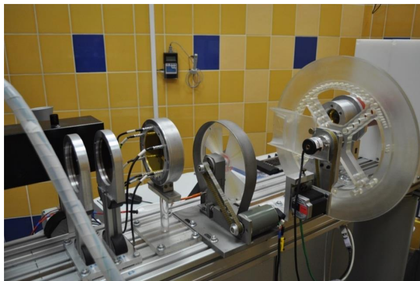
Rys. 2. Widok ławy optycznej z układami formowania i monitorowania wiązki. Od prawej: dyskryminator zasięgu, modulator zasięgu, przelotowe komory jonizacyjne.
