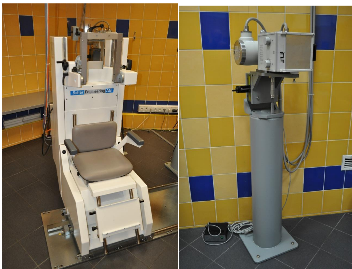
Rys. 3. Elementy układu pozycjonowania pacjenta: fotel terapeutyczny (po lewej) oraz jeden z dwóch aparatów RTG (po prawej).
