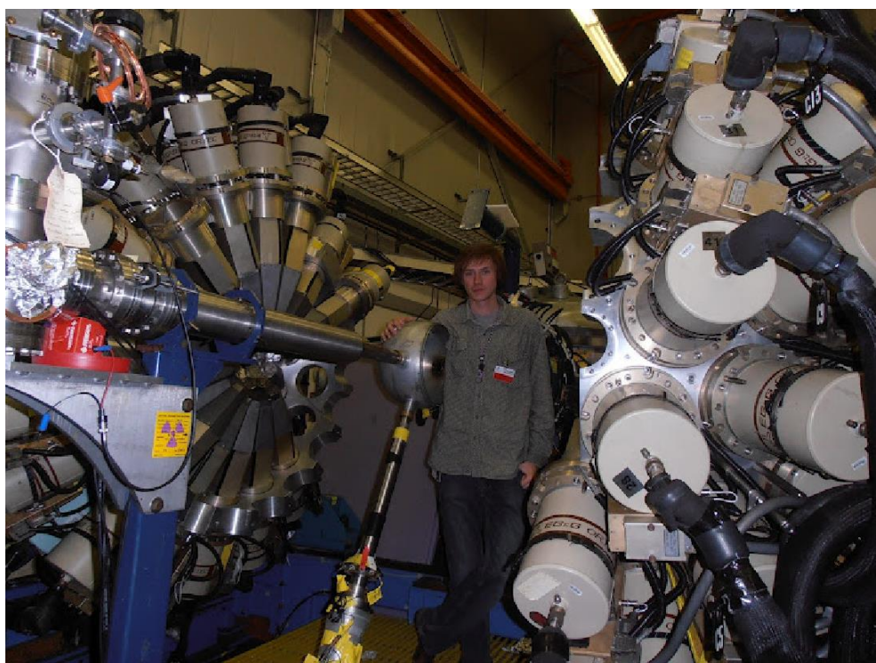
Rys. 4.2. Zdjęcie rozsuniętych półkul układu detekcyjnego Gammasphere.
