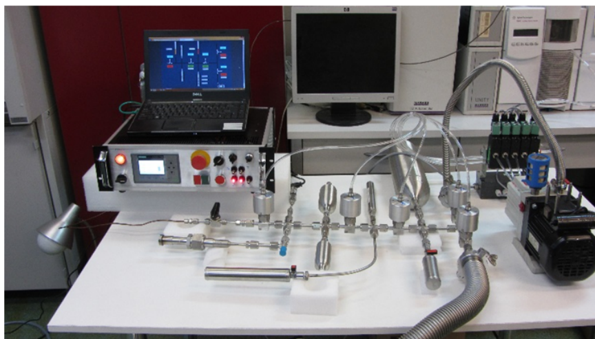
Rys. 6.6: Aparatura Sieverta w IFJ – widok ogólny
