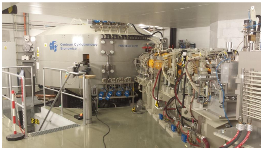
RYSUNEK 2.10: Cyklotron systemu Proteus 235 w CCB [68].
