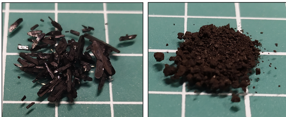
Rys. 3.6. Zdjęcia uzyskanych próbek Mn_{12}-acetate (po lewej stronie) i Mn_{12}-stearate (po prawej stronie)
