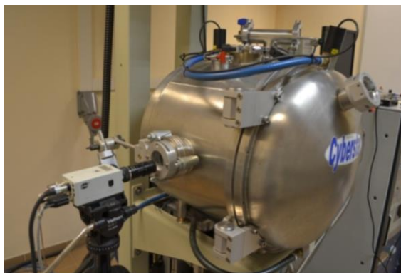
Rysunek 3.6 Kamera CCD stosowana do obserwacji procesów wzrostu kryształów [zdjęcie własne].
