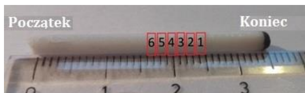
Rysunek 7.25 Kryształ LMP 398 z zaznaczonym początkiem i końcem procesu MPD oraz miejscem pozyskania próbek do pomiarów.
