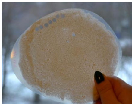
Rysunek 3.32 Folia LMP na bazie proszku \text{LiMgPO}_4:\text{Tb,B} (LMP 10) ze względu na liczne niejednorodności (na zdjęciu) nie została wykorzystana do dalszych badań [rysunek własny].
