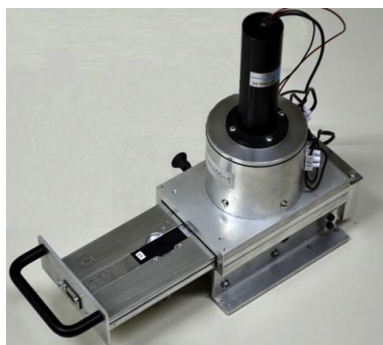
Rysunek 3.24 Czytnik HELIOS-1 z kasetą dozymetryczną wewnątrz szuflady pomiarowej [Marczewska i wsp., 2016].
