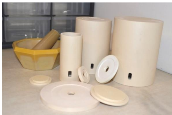
Rysunek 3.9 Izolacje cieplne tygla stosowane w procesach wzrostu kryształów oraz moździerz używany do proszkowania materiału wsadowego [zdjęcie własne].
