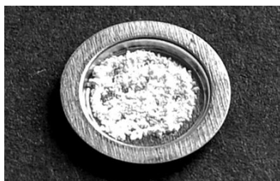
Rysunek 3.30 Przygotowana do pomiarów miseczka z luminoforem LMP 10 ( LiMgPO_4:Tb,B ) w postaci proszku [rysunek własny].
