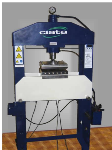
Rysunek 3.31 Prasa hydrauliczna używana do otrzymywania folii LMP [rysunek własny].
