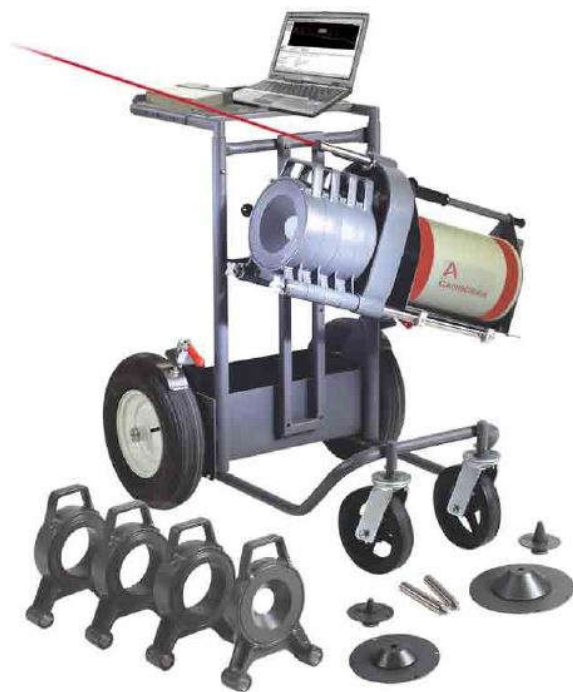
Rysunek 16. Detektor HPGe umieszczony na mobilnym wózku wraz z osłoną ołowianą i kolimatorami 30° i 90°. Na blacie wózka widoczny jest tor spektrometryczny oraz komputer do akwizycji i bieżącej analizy zebranych widm – z [84]
