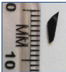
Rys. 5.26 Fragment płytki polikaptydowej domieszkowanej nanocząsteczkami magnetytu.
