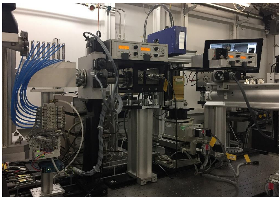
Rysunek V. 2 Widok układu pomiarowego przygotowanego do kalibracji energetycznej, na linii SuperXAS, SLS, PSI. W układzie nie ma zamontowanego kryształu analizującego.
