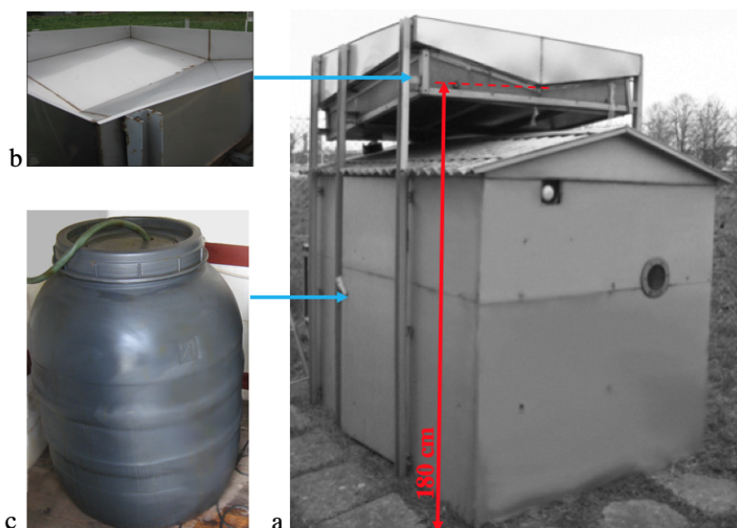
Rysunek 2.41: Kolektor całkowitego opadu atmosferycznego w IFJ PAN: a) widok ogólny, b) stalowa rynna kolektora, c) beczka służąca do gromadzenia opadu atmosferycznego połączona z rynną kolektora.
