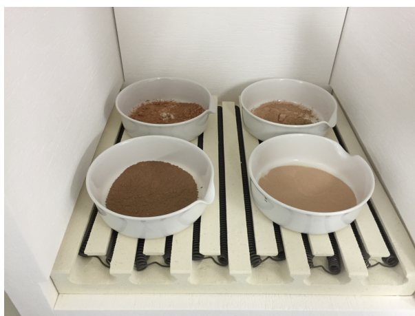
Rysunek 2.5: Badany materiał środowiskowy po spopieleniu w piecu muflowym w temperaturze 600\text{ }^{\circ}\text{C} przez 18 h.
