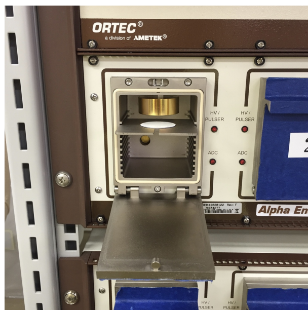
Rysunek 2.8: Komora spektrometru promieniowania alfa (Alpha Ensemble, ORTEC) z detektorem typu PIPS o powierzchni aktywnej 450 mm 2 oraz z widocznym źródłem alfa - spektrometrycznym (QST).
