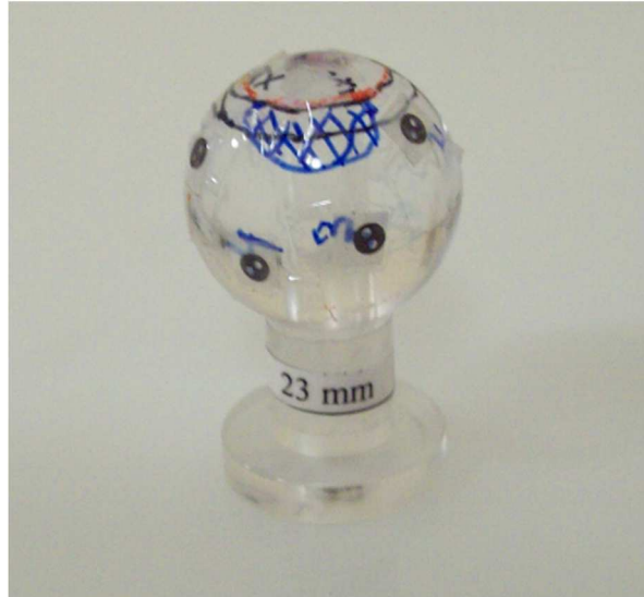
Rysunek 13.1. Zdjęcie fantomu gałki ocznej wykonanego z PMMA. Na fantomie naklejono markery tantalowe w pozycjach zgodnych z planowanymi miejscami naszywania markera na rzeczywistą gałkę oczną pacjenta (fot. J. Swakoń).
