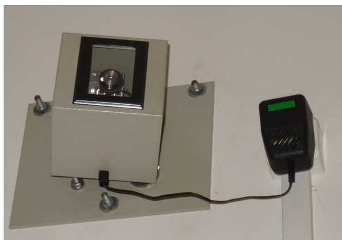
Rysunek 7.13. Pozycjonery laserowe na stanowisku radioterapii protonowej w IFJ PAN (fot. J. Swakoń).
