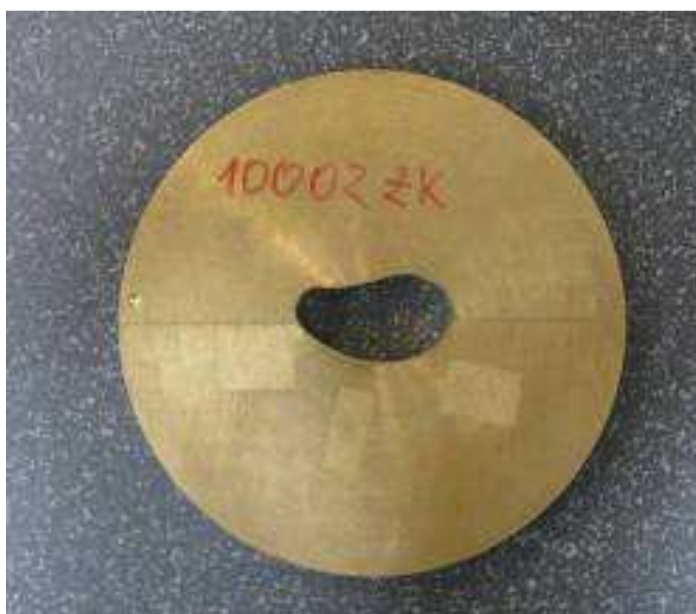
Rysunek 12.12. Zdjęcie indywidualnego kolimatora pacjenta. Kolimator przedstawiony na zdjęciu pochodzi z okresu prowadzenia pierwszych prac testów procedury radioterapii, dlatego identyfikator pacjenta nie jest grawerowany, ale wykonany piśmakiem wodoodpornym (fot. J. Swakoń).
