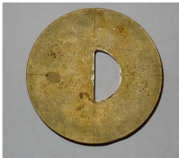
Rysunek 9.3. Zdjęcie kolimatora półwkowego, umożliwiającego pomiar profili poprzecznych wiązki w pobliżu osi wiązki (fot. J. Swakoń).
