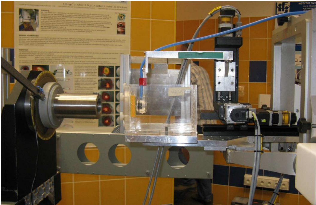
Rysunek 10.15. Fantom wodny z komorą Markusa, zainstalowany w położeniu w izocentrum stanowiska radioterapii protonowej na stanowisku radioterapii protonowej. Komora jonizacyjna Markusa jest zamocowana w uchwycie zamontowanym do skanera 3D , co umożliwia precyzyjne pozycjonowanie komory (fot. J. Swakoń).
