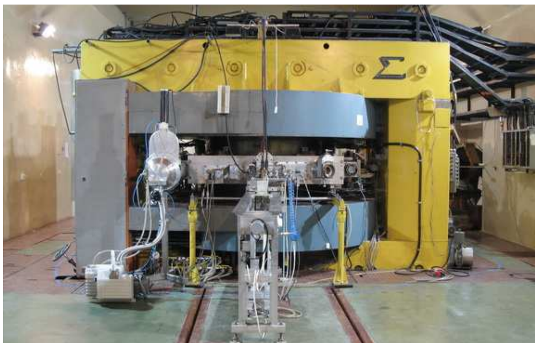
Rysunek 6.1. Widok cyklotronu AIC-144 od strony źródła jonów (na lewo od źródła jonów widoczne są elementy zmodernizowanego systemu próżniowego – pompy próżniowe: rotacyjna i turbomolekularna) (fot. J. Swakoń).
