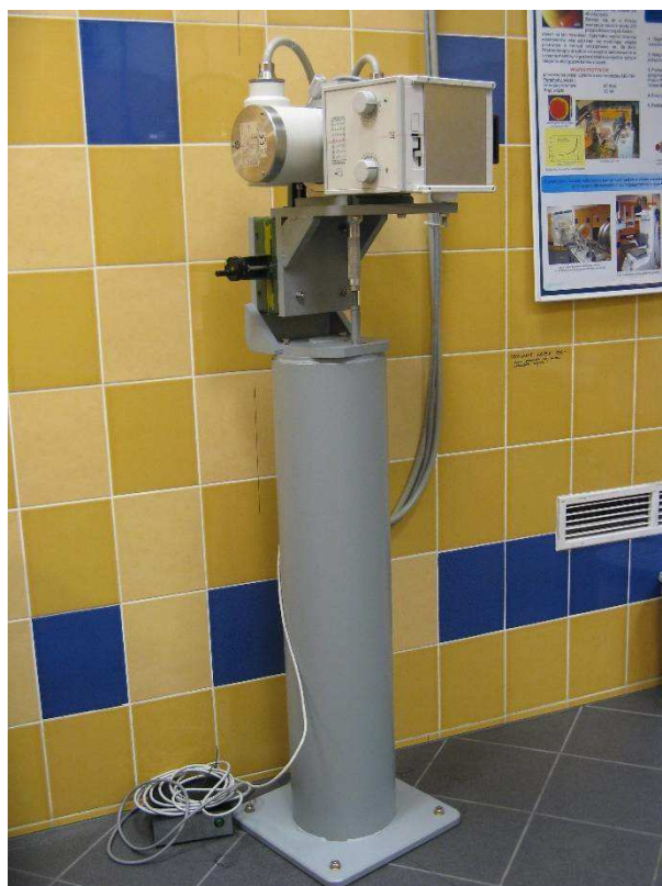
Rysunek 7.11. Lampa RTG wraz z kolimatorem zainstalowana na stanowisku radioterapii protonowej w IFJ PAN (fot. J. Swakoń).
