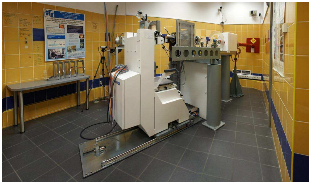
Rysunek 1.1. Stanowisko radioterapii protonowej nowotworów oka przy cyklotronie AIC-144 w IFJ PAN. Widoczny jest fotel do radioterapii protonowej oka oraz ława optyczna z zainstalowaną aparaturą (fot. D. Gil).
