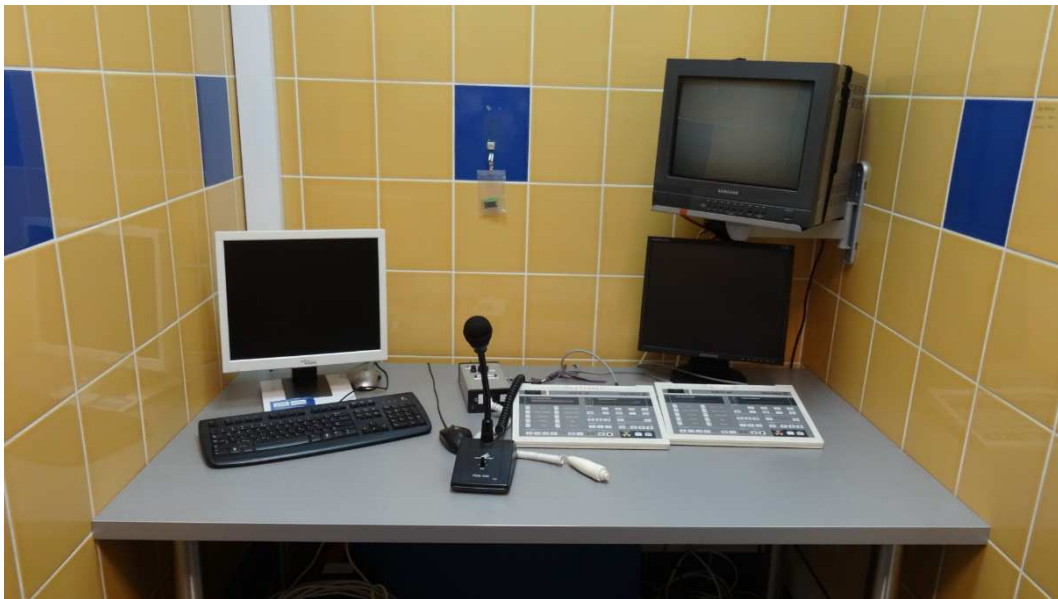
Rysunek 7.12. Widok wyposażenia sterowni RTG przy stanowisku radioterapii protonowej nowotworów oka w IFJ PAN. W sterowni aparatów RTG znajdują się niezależne konsole do generatorów RTG, wyposażone we wspólny układ wyzwalania, monitor umożliwiający podgląd oka pacjenta, monitor umożliwiający wyświetlanie zdjęć RTG oraz pozycji fotela oraz monitor prezentujący widok na halę, a w szczególności umożliwiający podgląd pacjenta siedzącego na fotelu. Zainstalowano tam również mikrofon do wydawania poleceń pacjentowi (fot. J. Swakoń).
