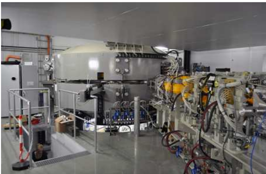
Rysunek 3.4. Cyklotron Proteus C-235 firmy Ion Beam Applications zainstalowany w Centrum Cyklotronowym Bronowice w IFJ PAN (fot. J. Swakoń).
