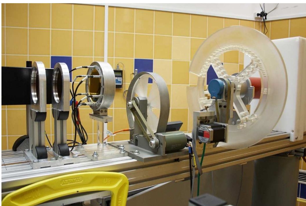
Rysunek 7.2. Elementy układu formowania wiązki ustawione na ławie optycznej oraz zestaw komór jonizacyjnych. Od lewej trzy komory jonizacyjne (dwie komory płaskorównoległe PTW 7862 i komora sześciosegmentowa), układ modulatora zasięgu, układ dyskryminatora zasięgu (fot. J. Swakoń).
