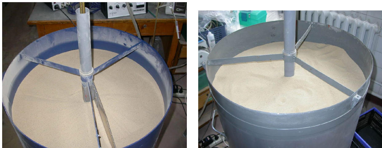
Ilustracja 7-1. Kalibratory sond gruntowych
