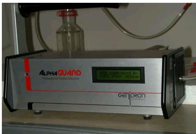
Ilustracja 6-1. AlphaGUARD PQ 2000 Pro f-my Genitron będący na wyposażeniu pracowni LPN IFJ PAN
