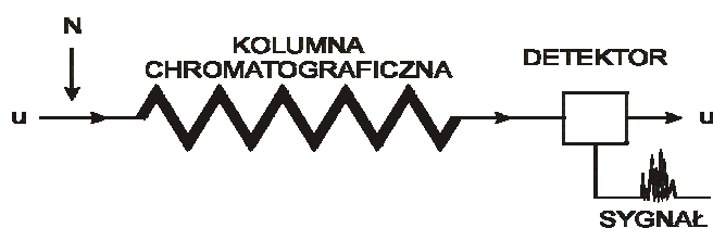
Rys. 6. Uproszczony schemat chromatografu gazowego. N - analizowana próbka, u - przepływ gazu nośnego (Śliwka, 2003).
