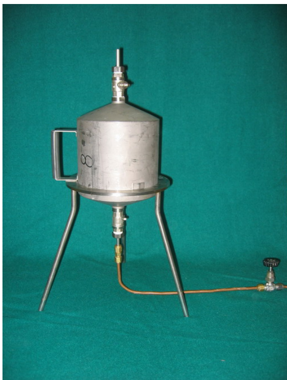
Rys. 16. Zdjęcie pojemnika pomiarowego zastosowanego do pobierania próbek wody podziemnej ustawionego na stojaku stalowym.
