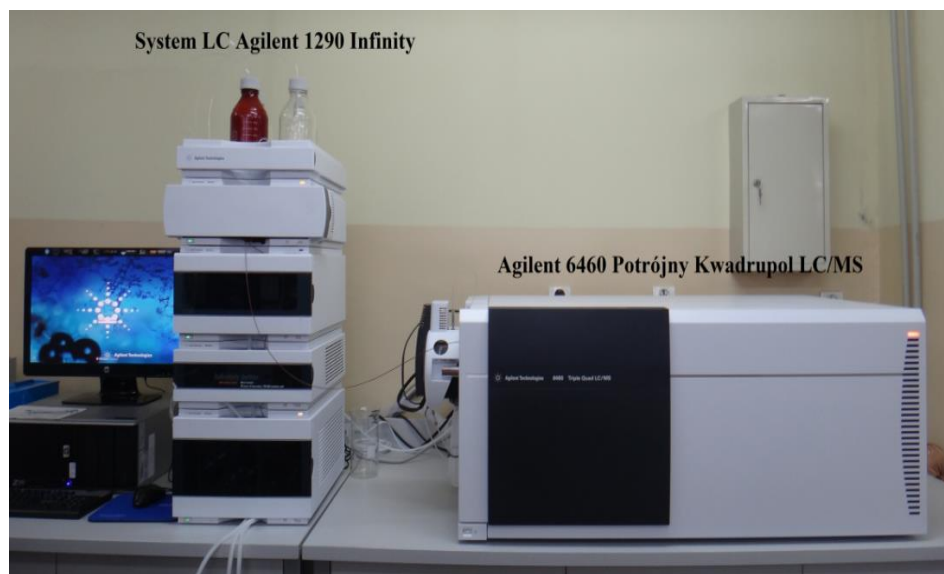
Rys.14 Układ LC-MS/MS pracujący w Zakładzie Fizykochemii Ekosystemów IFJ PAN.
